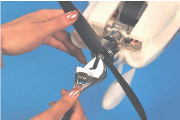
Die Luftschraube wird mit der Mutter am Mitnehmer befestigt. Anschließend wird der Spinner festgeschraubt.
