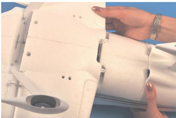
Die Zapfen an der Tragflächenvorderkante müssen in die Nuten einrasten.
